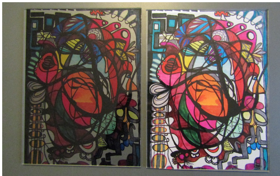
Print på glas. Kunstværket til venstre er printet med farver, der ikke er heldækkende, så der stadig kommer lys gennem glasset, men indkig forhindres. Til højre ses samme kunstværk printet med heldækkende farver og hvid baggrund. Begge print er lavet på 4 mm floatglas. Foto er printet af Signcom med en Mimaki UV-led printer.
