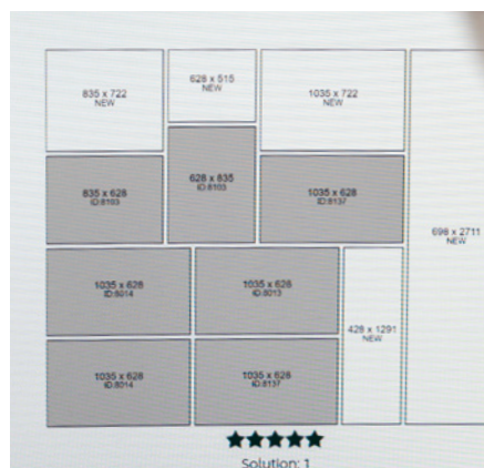
Eksempel fra AI-softwaren, som designer og detailprojekterer facadepartierne med produktionsdata til fremstillingsprocessen.
