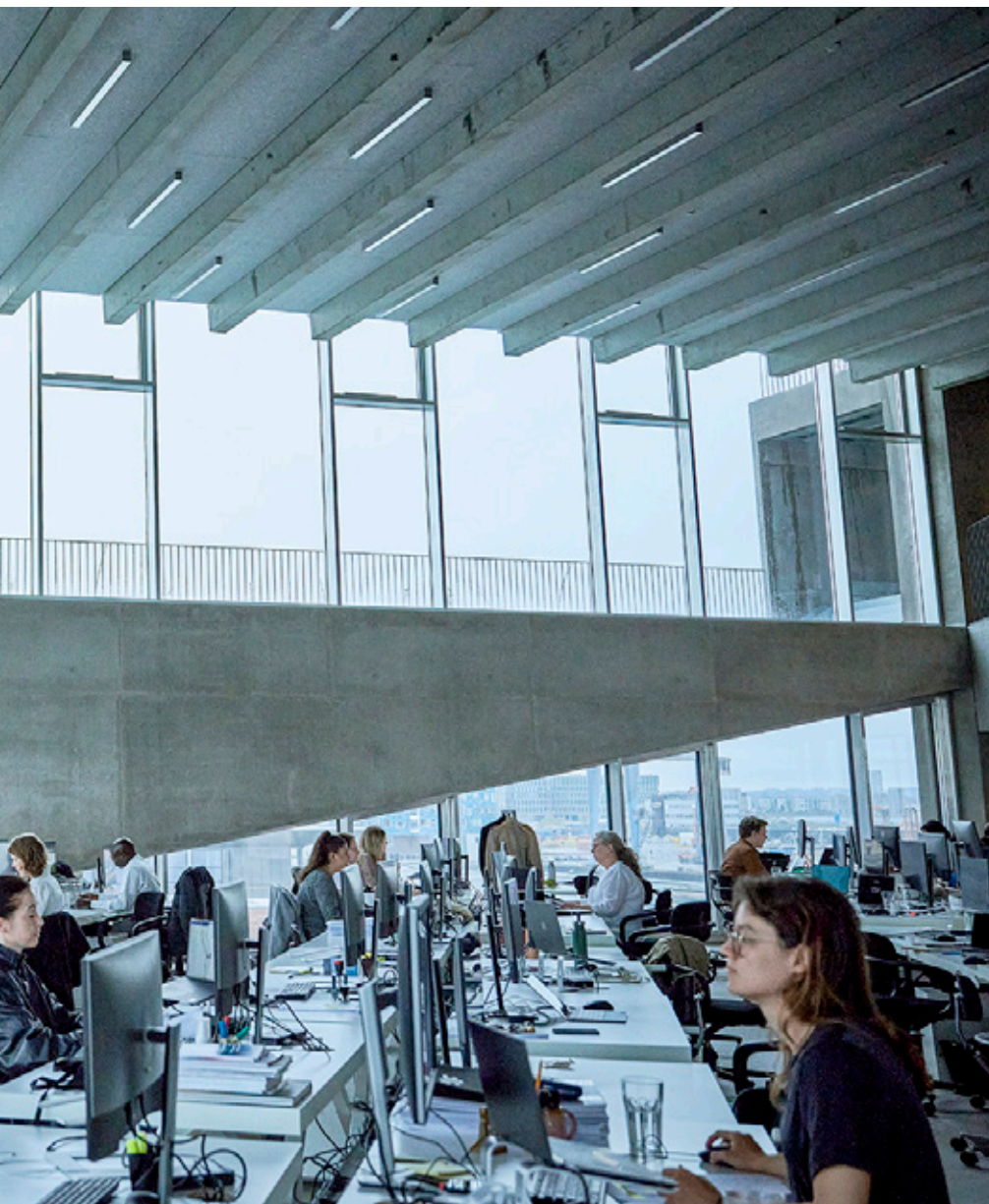
Intelligent udluftning med fuldautomatiske vinduer. BIG HQs klimavenlige design har fravalgt traditionelt ventilationssystem til fordel for fuldautomatiske vinduer, der åbner og lukker alt efter CO 2 -niveauerne på hver etage. Løsningen kombinerer energieffektivitet med sikkerhed, idet vinduerne samtidig opfylder EI60-brandkravene.
